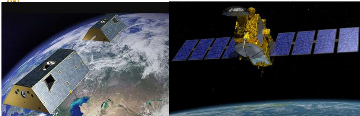
Рисунок 1. Аппараты космической гравиметрической миссии GRACE (слева) и альтиметрической миссии Jason (справа)[4,5].
