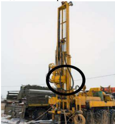
Рисунок 1. Особенности бурения скважин в зимних условиях. На фото выделено наиболее уязвимое место изгиба РВД гидросистемы УРБ при спуско-подъемных операциях
