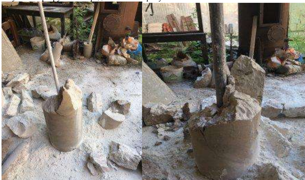
Рисунок 4. Результаты разрушений бетонных моделей с помощью НРС со вставками
