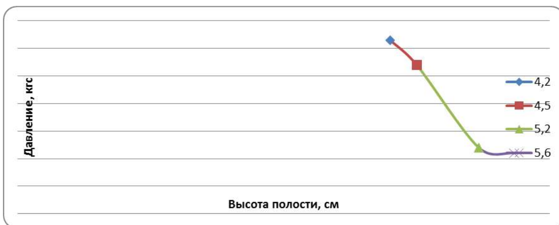
Рисунок 2. График влияния нагрузки на высоту полости в образце
