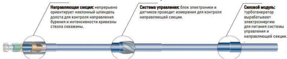
Рисунок 2. Роторная Управляемая Система Xceed
