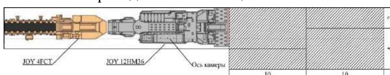
Рисунок 1. Технология ведения очистной выемки камеры комплексом с комбайном JOY 12NM36.
