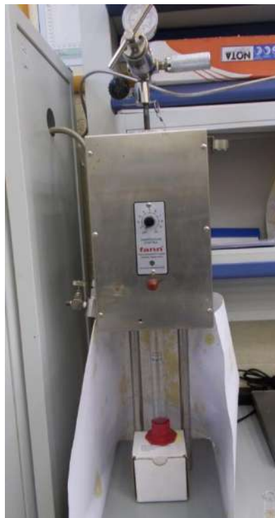
Рисунок 1. Фильтр-пресс НТ-НР с возможностью использования керамических дисков
