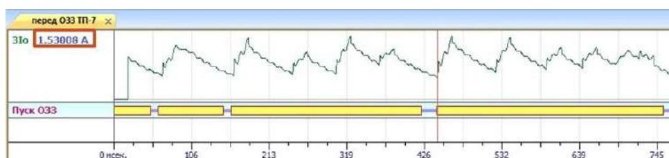
Рисунок 2. Осциллограмма действующего значения тока нулевой последовательности поврежденной линии в режиме КрОЗЗ
