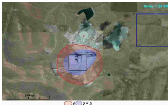
Рисунок 2. Геоэлектрические аномальные зоны над кимберлитовой трубкой «Letseng-La-Terae» (Королевство Лесото). 1 – зона регистрации откликов на резонансных частотах кимберлитов; 2 – зона регистрации откликов на резонансных частотах алмазов; 3 – точка вертикального сканирования.
