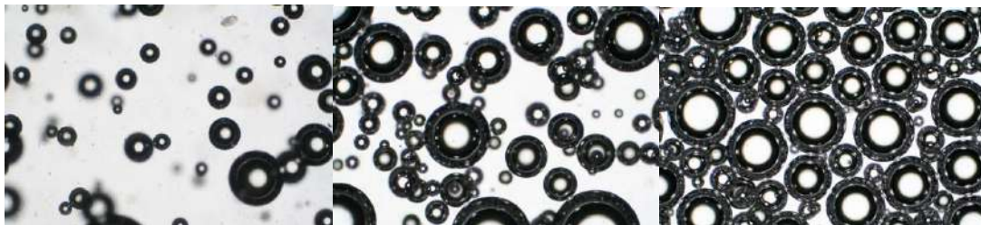
Рисунок 1. Фотографии под микроскопом БРМП различных концентраций ( C=0,3\% ; 0,4\% ; 0,6\% – слева на право)
