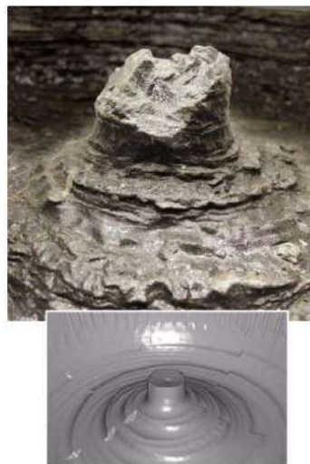
Рисунок 3. Образующийся микро-кern горной породы
